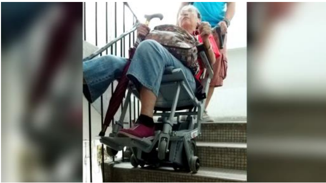
GIA 評估項目之一：香港社會服務聯會「落得樓」服務的樓梯機裝置。
